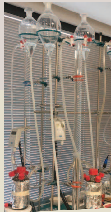
Impianto sperimentale di biometanazione Bo-Aset localizzato e attivo nel laboratorio di analisi ambientali Aset
